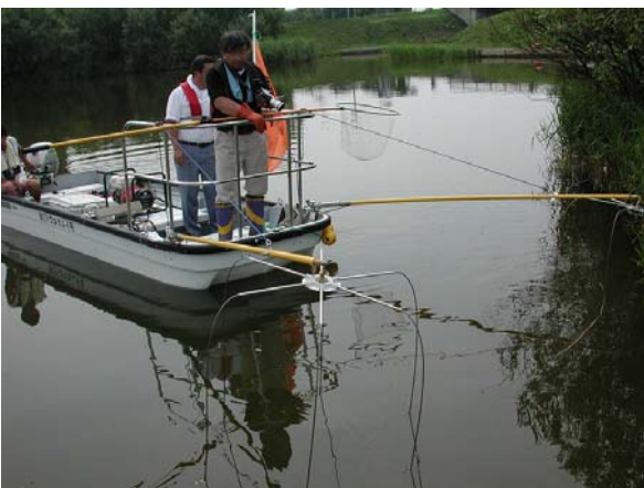
図 6 電気ショッカーボートの船首部と電極
