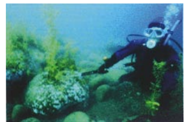
図4 潜水による限界付着力測定
