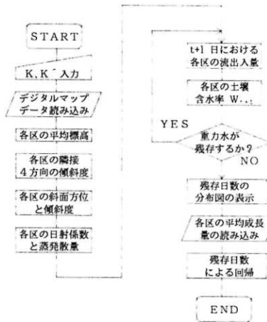
図-2 土壤重力水の残存日数計算 (プログラムのフロー図)
