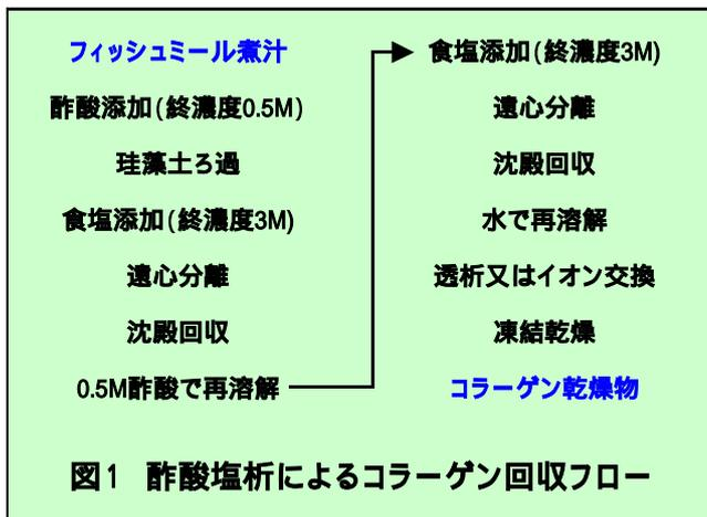
図1 酢酸塩析によるコラーゲン回収フロー
