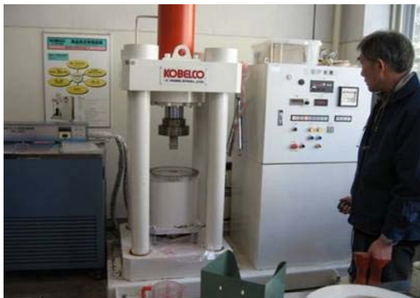
写真1 超高压処理装置
