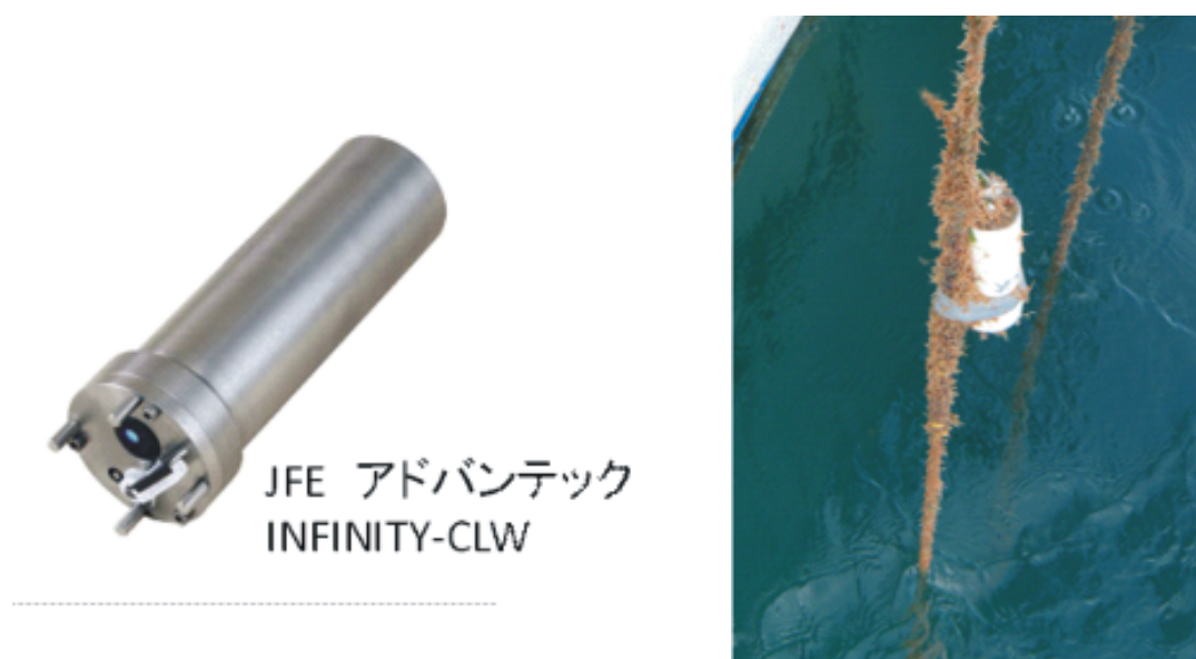
図 1 クロロフィル a 連続記録計 (左) とメンテナンスのために引き上げたところ (右)
