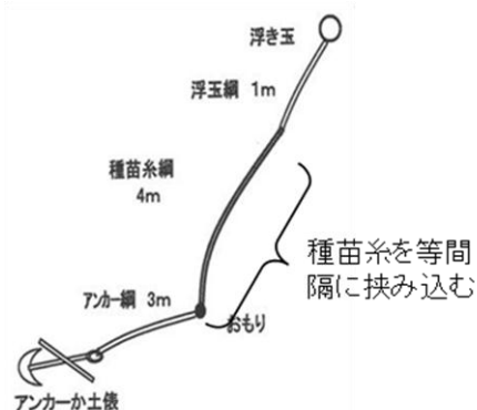
図2.試験に用いた立て縄式養殖施設
