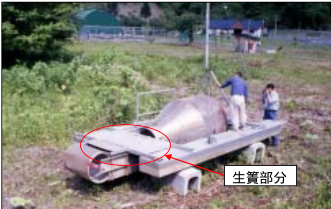
写真6 降下する稚魚を効率的、連続的な採集を可能とするスクリュートラップ（乙部町の突符川での設置状況）。中央のコーンが流れを受けて回転し、後部に接続された生簀まで魚はダメージを受けることなく導かれていきます。
