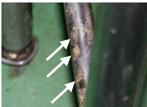
図1 ステンレス製作業台の脚部に付着したバイオフィーム（矢印で示した茶色の汚れ）
