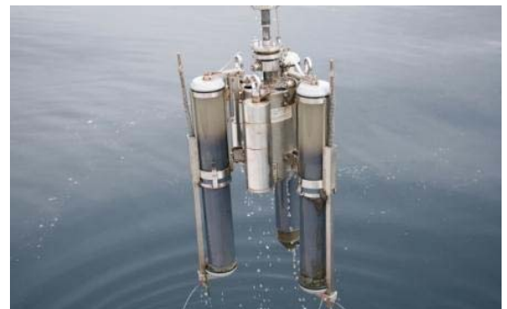
写真2 アシユラ採泥器での採泥
