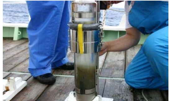
写真1 不攪乱採泥器での採泥
