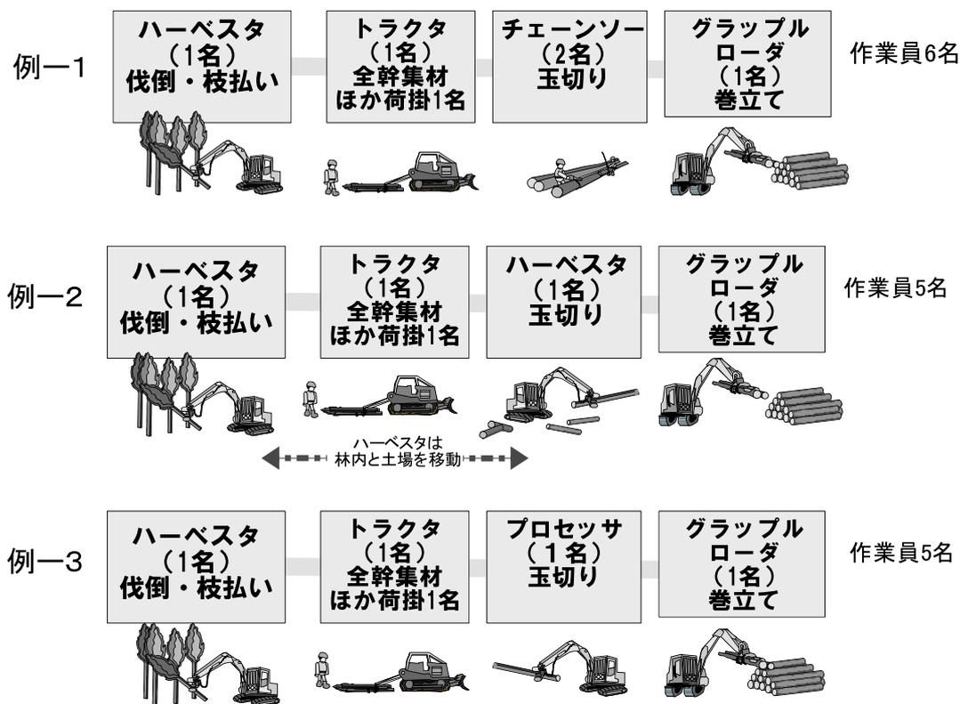
図-8 作業システムの例 (ハーベスタを林内で伐倒・枝払いに用いる場合)
