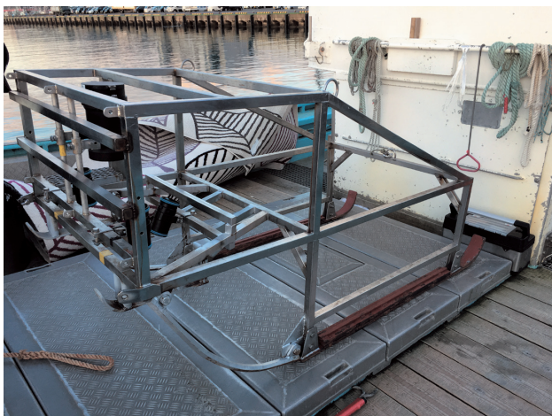
図2 改良されたけん引式撮影装置
