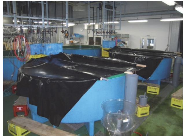
図11 大型水槽を用いた量産試験の様子（水槽上面を遮光幕で覆い、水槽内で幼生の分布が上層に集中することを防げるか試験しています）
