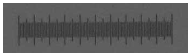
図5 APS-Cサイズ2,420万画素のデジタルカメラで「等倍」撮影した対物マイクロメーター(最小目盛0.01 mm = 10 \mu\text{m} )
