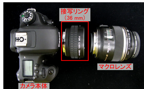
図12 ホタテガイ浮遊幼生（1.9倍）撮影のための36mm接写リングの装着
