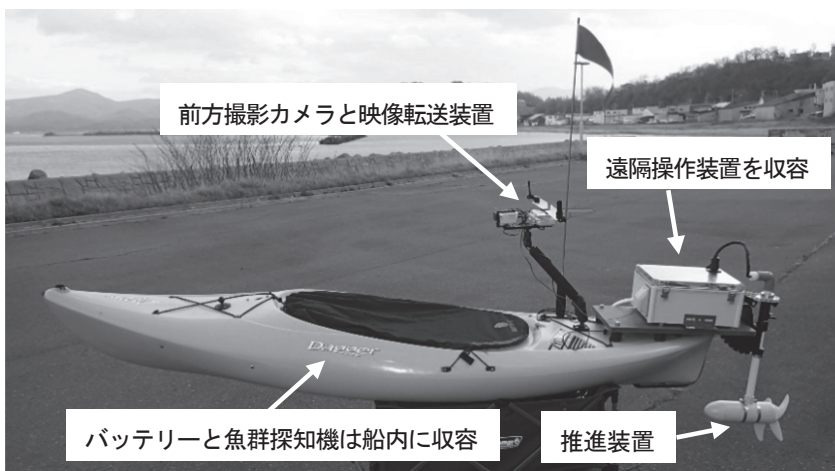
図1 調査用ラジコンボートの写真と主要装備
