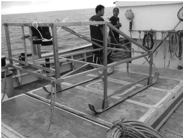
図2 けん引式海底動画撮影装置
