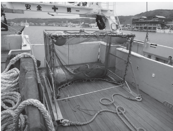
図1 ホッコクアカエビ資源調査のために製作した深海ソリネット
