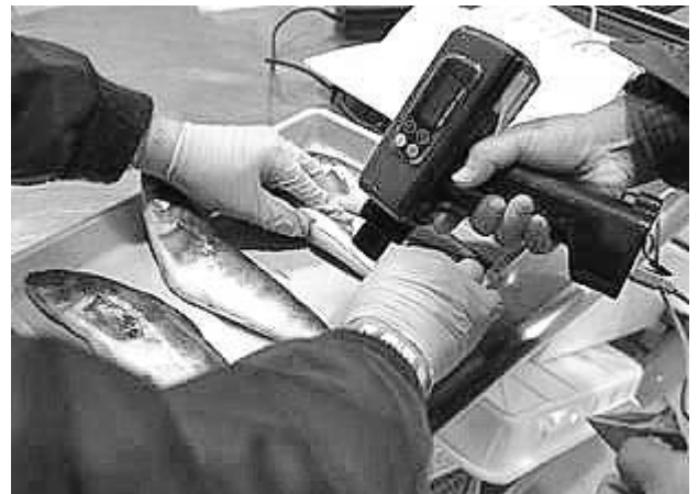
写真2 NIR-GUNによるホッケ背肉部の近赤外 分光分析の様子
