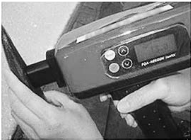
写真1 ポータブル型近赤外分光測定機 NIR-GUN (静岡製機株式会社製)
