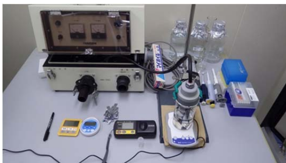
写真1 電解海水の装置
