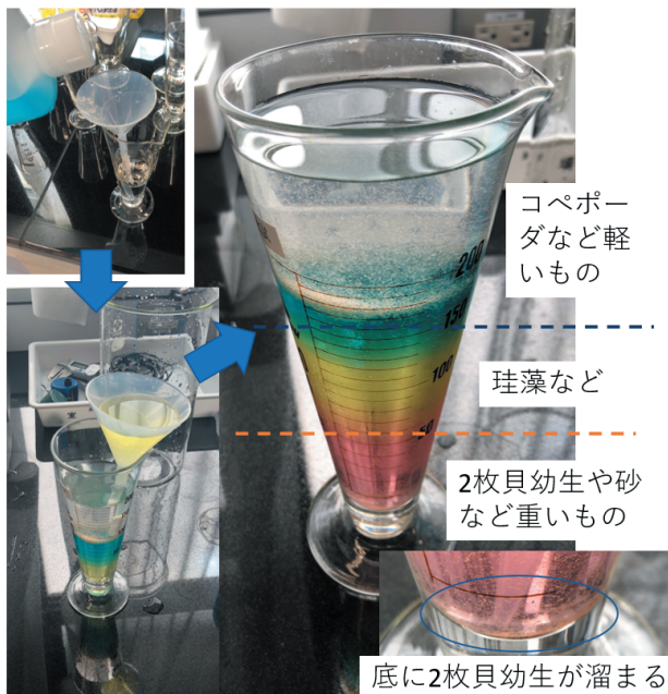
図1 砂糖水を用いてプランクトンサンプルから二枚貝幼生を選別する方法 青、黄、赤色の順に砂糖水の濃度が濃くなっている（色は視認しやすいように着色）
