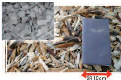
写真ー2 完成したチップおよび切削チップ(左上)
