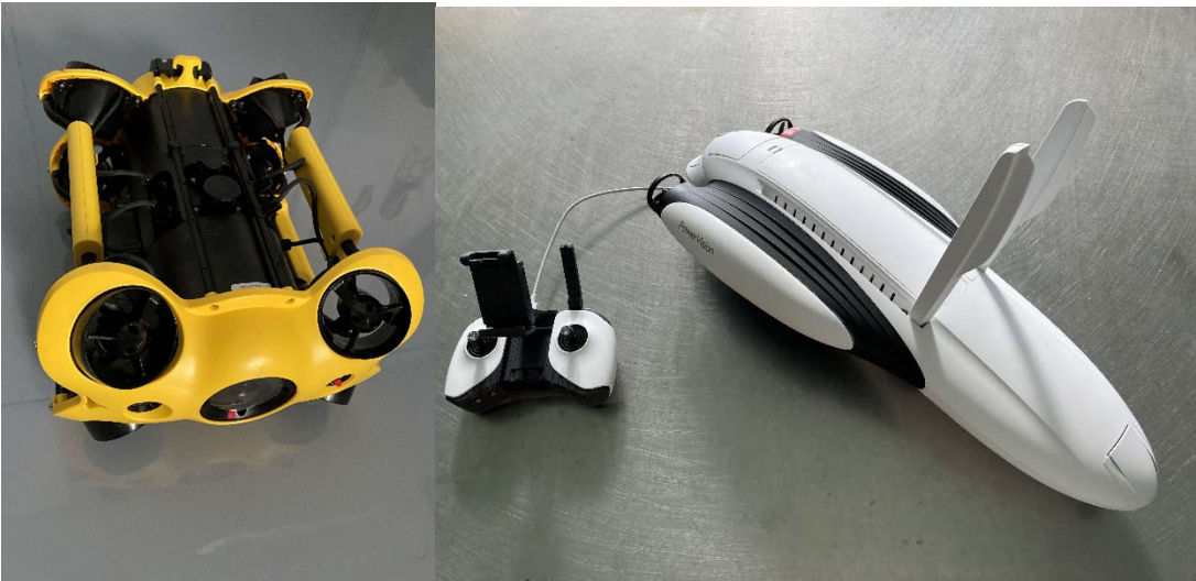
図3 水中ドローン（左）と水上ドローン（右）
