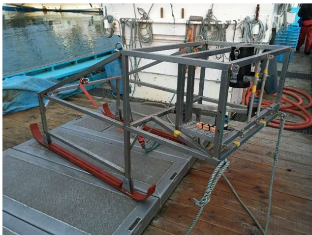
図1 地まきホタテガイ漁場撮影のためのけん引式撮影装置の外観
