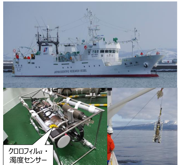
図 2 （上）新造された北洋丸 （下）CTD に追加されたクロロフィル・濁度センサーと観測の様子
