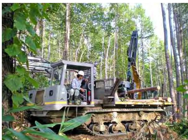
写真-6 ハーベスタによるフォワーダ荷台積込み
