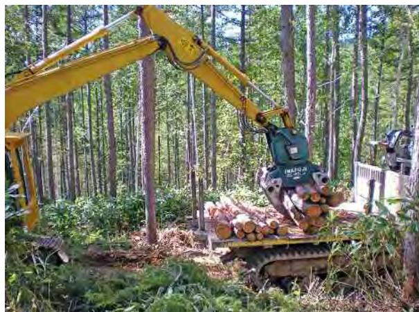
写真-5 グラップルによるフォワーダ荷台積込み
