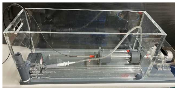
図 4 さけます内水試に導入したスイムトンネル型呼吸計
