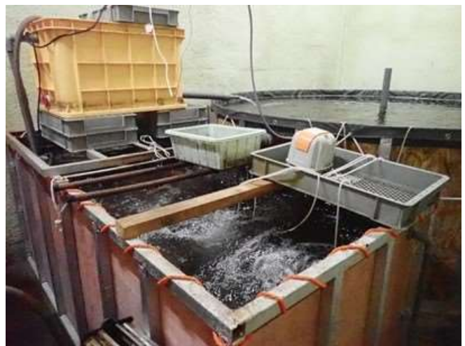
図3 民間養魚場で稼働中の閉鎖循環型飼育システム
