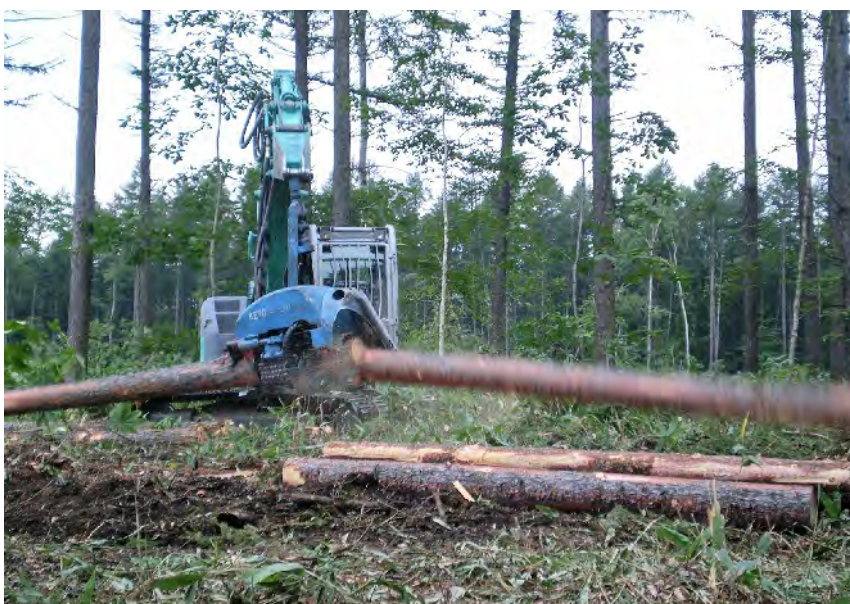
写真-1 ハーベスタによる造材・巻立て作業風景
