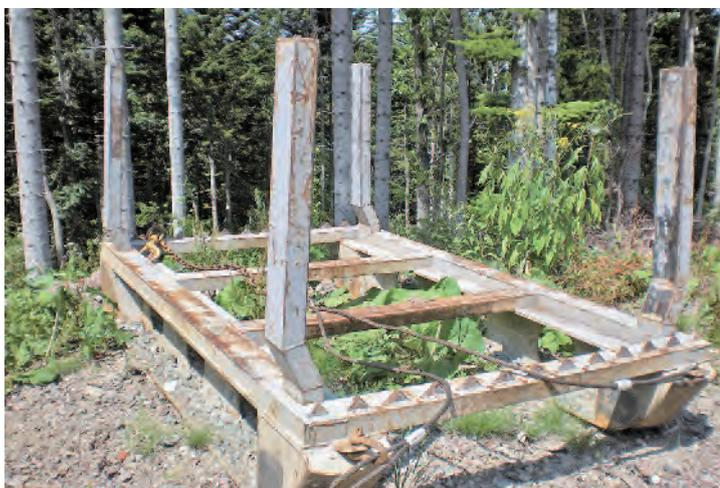
写真-1 土そりの例 (長さ3m×1.9m×高さ1.5m)
