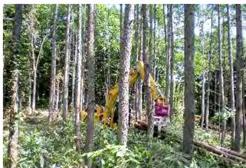
写真-6 林内に集積された全幹材を木寄せするグラップルローダ
