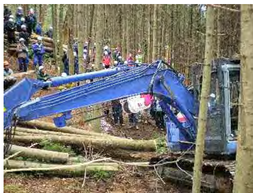
写真-3 ウインチが付いたグラップルローダの例 (左：ヘッドとウインチが一体化したタイプ、右：アーム下部にウインチが装着されたタイプ)
