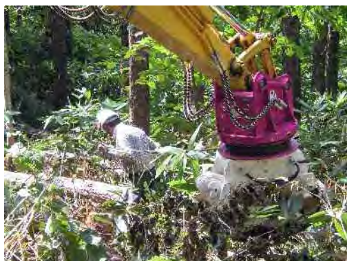
写真-3 ウインチが付いたグラップルローダの例 (左：ヘッドとウインチが一体化したタイプ、右：アーム下部にウインチが装着されたタイプ)
