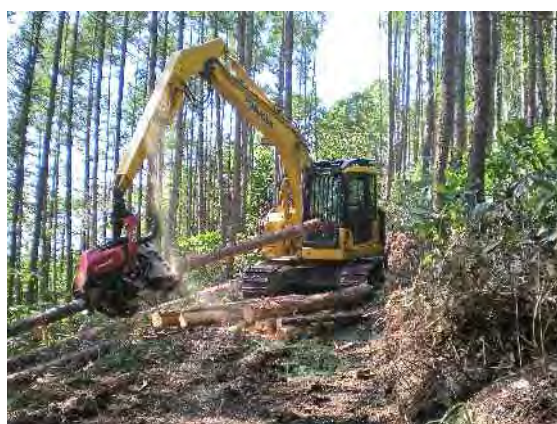
写真-9 作業路上で玉切りし、短幹材を集積するハーベスタ
