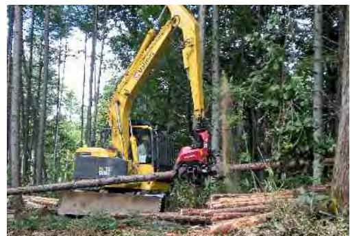
写真-7 作業路に木寄せされた全幹材をハーベスタで玉切って短幹材にして集積する
