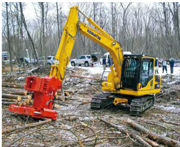
写真-1 伐倒アタッチメントを装着したフェラーバンチャ
