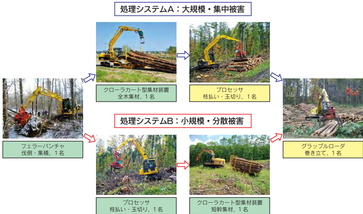
図-1 開発した風倒木の処理作業システム (背景色が緑色は林内, 黄色は土場での作業を示す)
