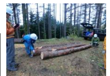
丸太のヤング係数の測定
