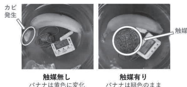
図3 プラチナ触媒による未熟果バナナの貯蔵試験
