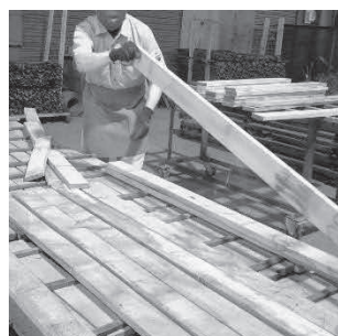
図2 原板の歪み検査
