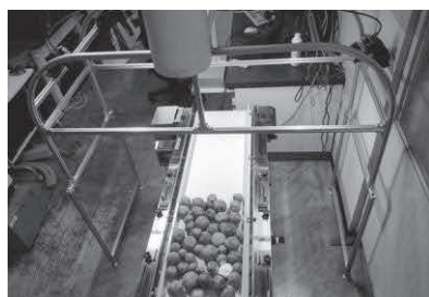
図1 外観検査・教示装置
