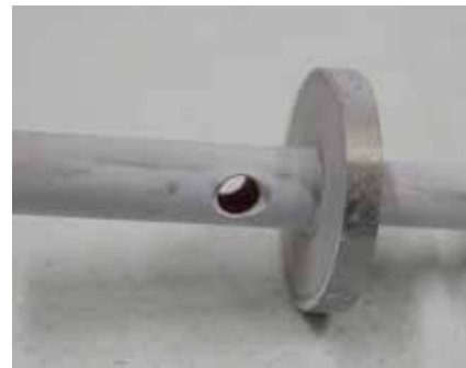
浸透探傷試験による亀裂の確認 (もしも亀裂があれば先に塗布した赤い塗料が染み出す。)
