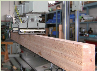
実大材の曲げ強度試験
