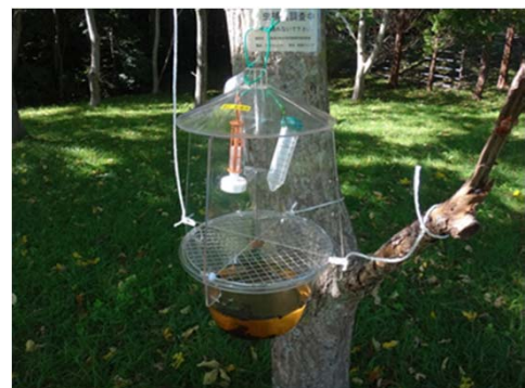
図-2 設置した衝突板トラップ
