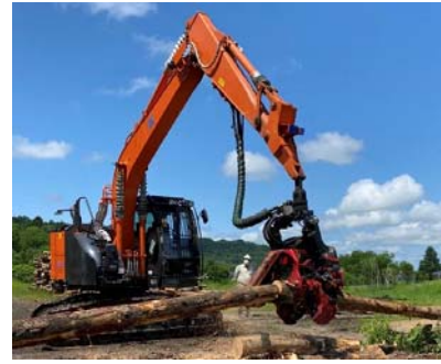
写真-1 ワラタ社製のICT機能を有するハーベスタ
