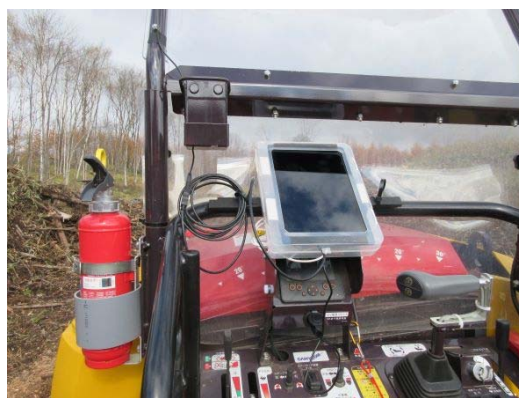
写真-1 山もっとモットに取り付けられた位置誘導装置(タブレットのモニターに進行方向が表示される)
