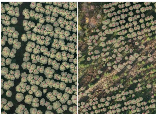
図-3 UAV画像からAIで抽出したアカエゾマツ樹冠 抽出されていない部分は広葉樹やカラマツの樹冠
