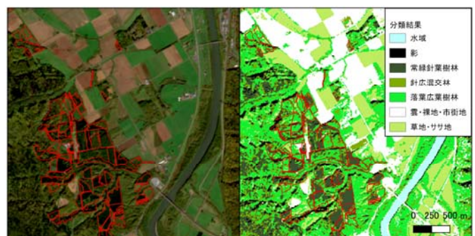
図-4 トドマツ、アカエゾマツ人工林の分布（赤線）と衛星画像（左）の教師無し分類結果（右）（2021年10月14日Sentinel-2A画像、解像度10m）
