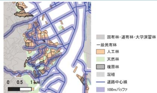
図-1 人工林と路網の配置 道路中心線は国土地理院数値地図のデータをもとに、踏査により修正。森林の区画は北海道の森林区域データによる。
