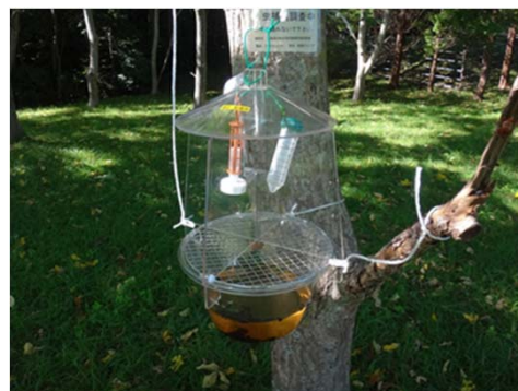
図-2 設置した衝突板トラップ
