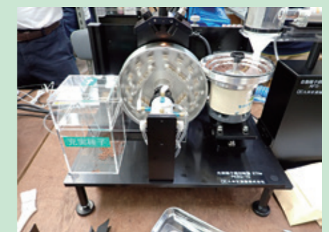
写真-5 林業試験場で購入した近赤外光種子選別機
