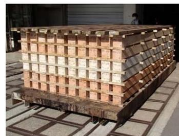
図3 製材の人工乾燥
