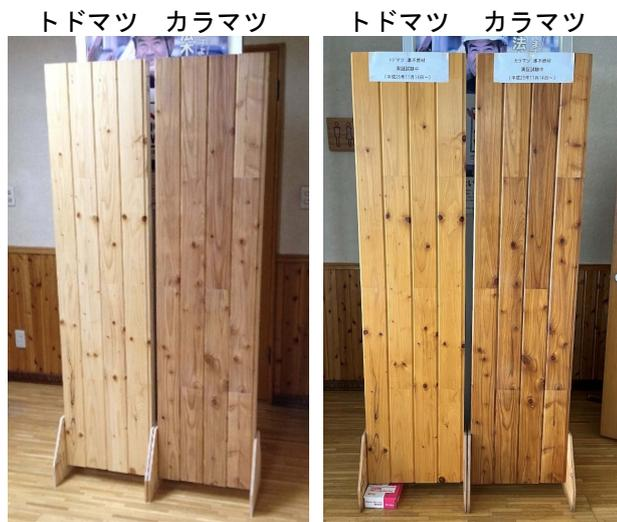
写真2 屋内暴露試験の外観（森町）
