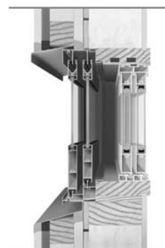
(a) 内窓改修
