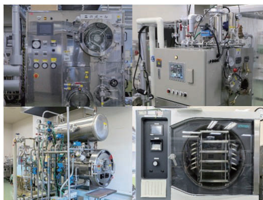
左上：遠心式薄膜真空蒸発装置 右上：短時間調理殺菌装置 左下：レトルト殺菌機 右下：真空凍結乾燥機
