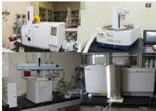
左上：ガスクロマトグラフ質量分析計 右上：味認識システム 左下：におい識別装置 右下：粒度径分布測定装置
