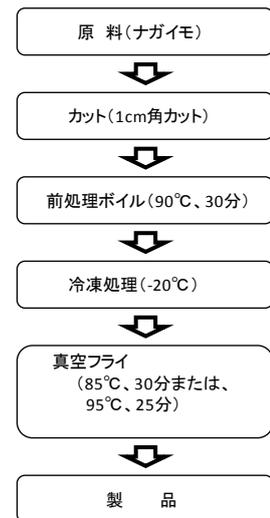
図2 ナガイモを用いた真空フライ食品の製造フロー
