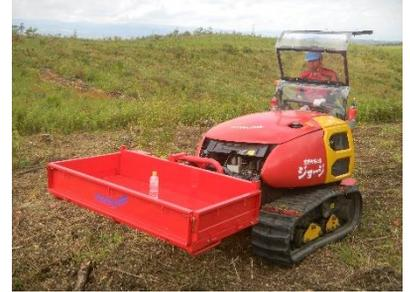
コンテナ苗などを運べる荷箱。水平維持機構が備えられており傾斜地でも荷崩れ無しで運搬可能
