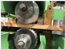
インサイジング処理されたラミナのパネル化により、インサイジング処理された大判CLTの製造を可能にしました。
