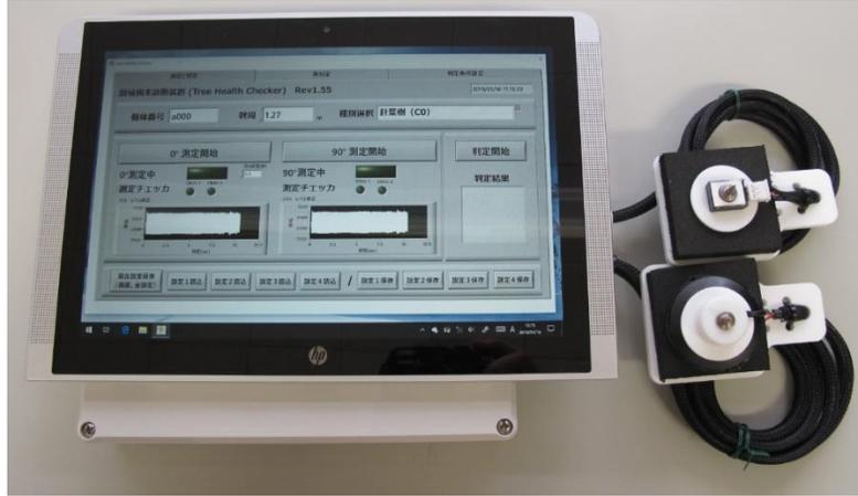
樹木内部欠陥簡易診断装置（THC）一式の外観
