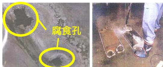
腐食による水の漏洩      分解・洗浄が手間
