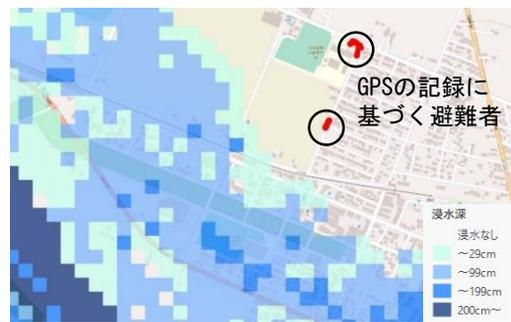
GPSの記録と津波浸水シミュレーションの可視化
