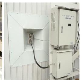
ダスト濃度自動計測器システム
