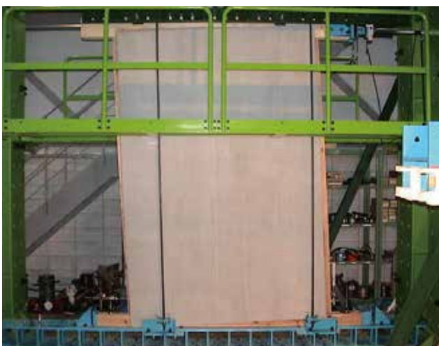
① 標準的な施工方法で作った モルタル外装壁
