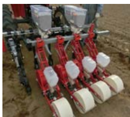
4条の播種機に対応する局所施肥ユニット(約420万円)
