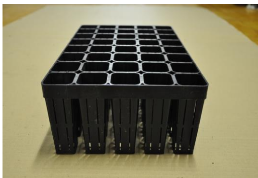
写真－1 試験に使用したサイドスリット付きのコンテナ容器 セルの容量が120c，セル数は40個／コンテナ
