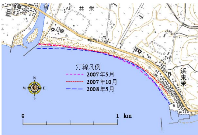
図2 GPSによって測量した汀線の季節変化 国土地理院発行 25,000分の1地形図を使用。
